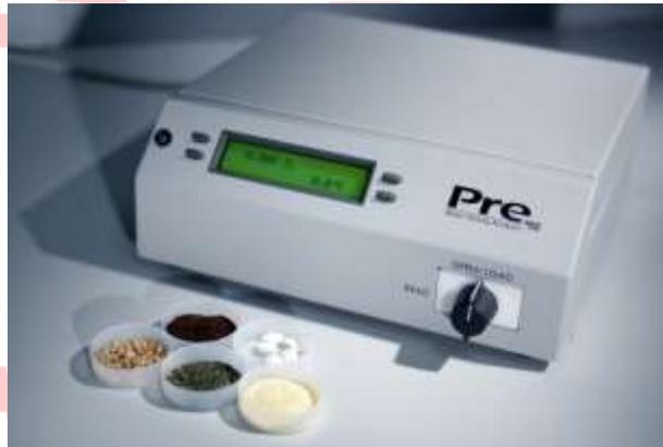
medidor de actividad de agua robusto con un diseño simple y sin límites de funcionamiento. El medidor de actividad de agua aw AquaLab PRE tiene un sensor de Punto de Rocío que es el método de referencia para medir la actividad de agua en la industria alimentaria, farmacéutica, cosmética y veterinaria.
